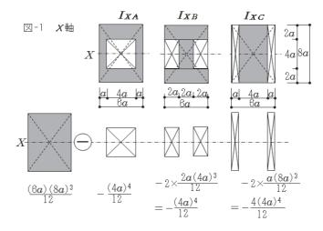
A、B、C 断面の場合は、図-1 に示すように中空部分又は欠損部分を含んだ長方形断面の断面二次モーメントから、それぞれの中空部分又は欠損部分の断面二次モーメントを差し引いて求める。
