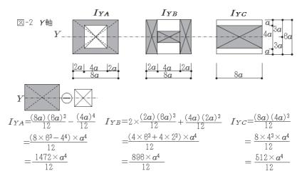
B断面のようなH形断面の断面二次モーメントは、図のようにY軸に関する3つの断面に分割し、それぞれの断面二次モーメント求め合算して求めることができる。
