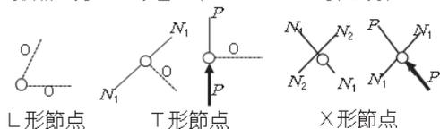
問題のE節点とF節点は、T形節点であるので、部材EBと部材FBは力が生じない**ゼロメンバー**となる。よって、B節点は、X形節点となり、作用線が一直線となる力は、大きさが等しく、向きが反対でつり合うので、AB部材の応力  $N_{BA}$  は上向き  $P$  でB点の荷重  $P$  とつり合う。B点を引張戻しているので引張力である。
