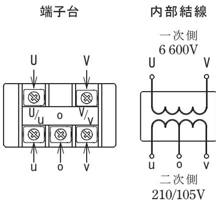
図3. 自動点滅器代用の端子台説明図
